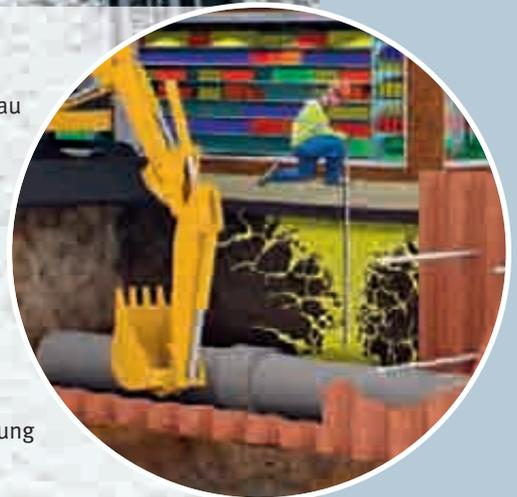
Das Zweikomponenten-Expansionsharz wird in flüssigem Zustand in den Boden injiziert. Fast augenblicklich erfolgt die Expansion in alle Richtungen, vornehmlich dorthin, wo der geringste Widerstand herrscht. Schon nach kurzer Zeit ist das Kunstharz tragfähig. Die ersten Anzeichen einer Anhebung (Laserkontrolle) weisen darauf hin, dass die notwendige Verstärkung des Fundamentuntergrundes an dieser Stelle erreicht ist. Mit weiteren Injektionen sind millimetergenaue Anhebungen möglich.
