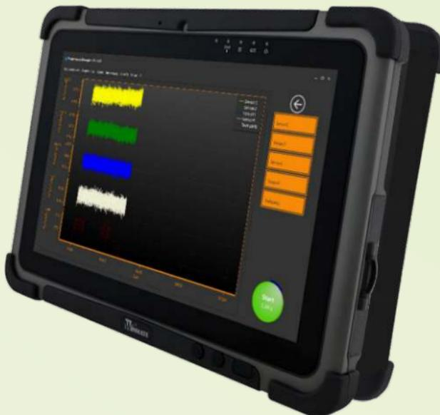
Eine Abtastfrequenz von 50 kHz scheint erst einmal hoch zu sein. Doch für die Wälzgerätdiagnose verwendet man die Hüllkurvenanalyse. Diese ist in der Lage, die von Wälzlagenschäden erzeugten Stoßimpulsfolgen zu extrahieren, welche per Faltung mit beliebigen Systemeigenschwingungen verknüpft sind.
