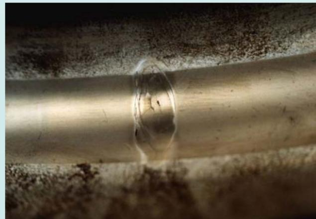
Mangelschmierung kann aber auch die Ursache für Reibungskontakt zwischen festen Körpern sein. Aus der Oberflächenschicht wird Material abgetragen. Dies ist Verschleiß.
