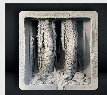
Die uCube-Farbnebelbox lässt sich zur Farbnebelabscheidung in Lackieranlagen einsetzen. Damit lassen sich bis zu 30 Kilogramm pro Box an Farbnebel auffangen.
